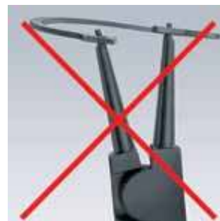
Běžné kleště pro pojistné kroužky: možné zkroucení kroužku při montáži
