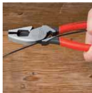
09 11/12 240: Vtahovací přípravek na kabely v mezeře kloubu
