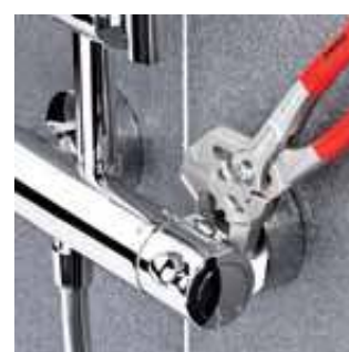
Práce s chromovanými armaturami bez poškození povrchu
