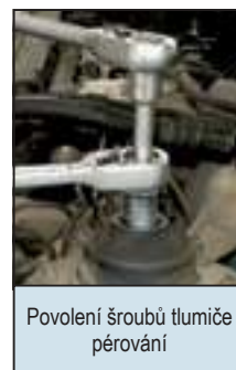
Utažení šroubu tlumiče pérování (dotažení momentovým klíčem)
